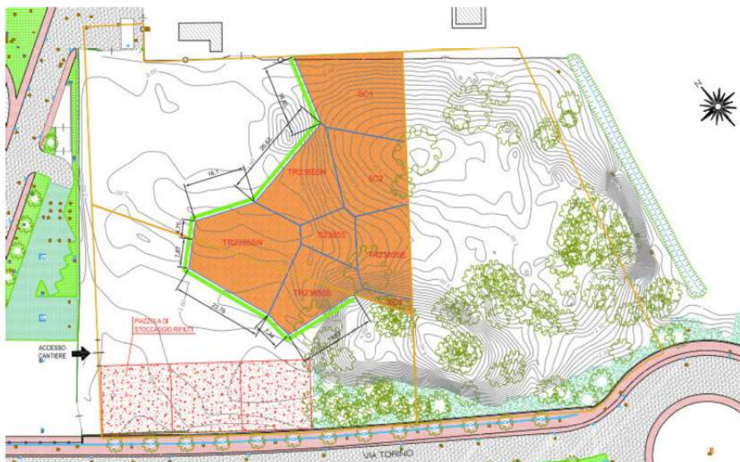
Fig. 36: piazzole di stoccaggio rifiuti
