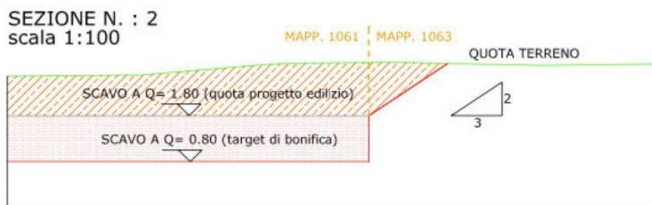
Fig. 30: sezioni tipo di scavo
